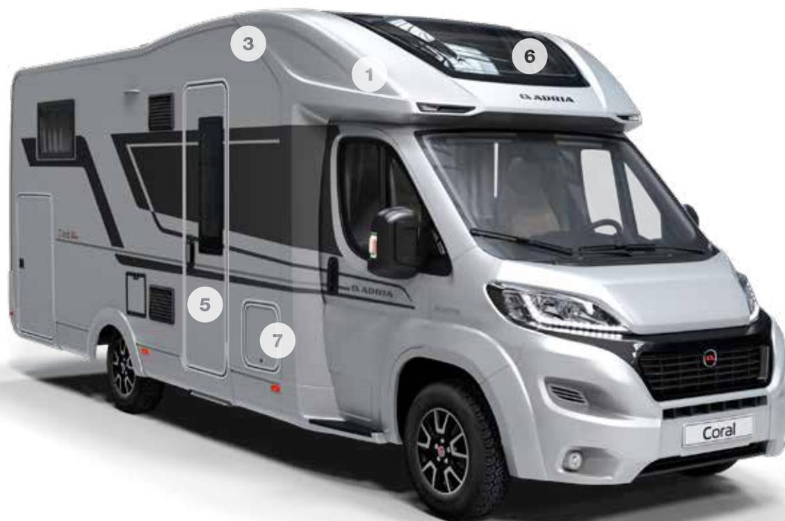
**1** Schlankes neues Außenprofil und Frontabdeckung mit integrierter Beleuchtung.
