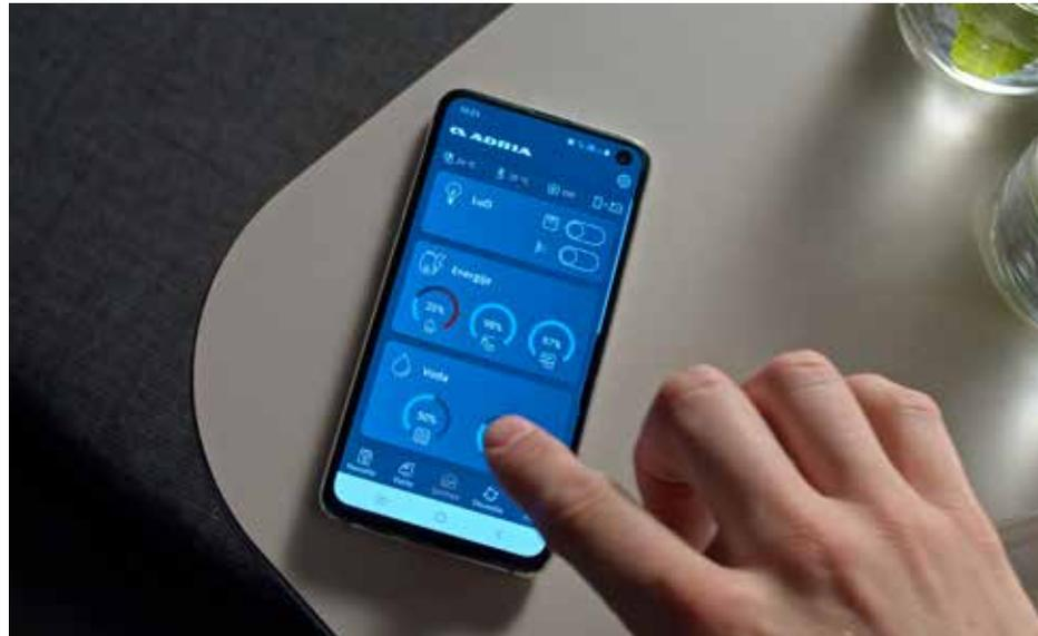
**MACH** nutzt Bluetooth® zur lokalen **Steuerung** der wichtigsten Funktionen (Bedienfeld, Heizung, Klimaanlage\*\*, Kühlschrank, Wasserpumpe, Wassertankfüllstände und Batteriestatus). Ermöglicht zudem die Überwachung der Außen- und Innentemperatur und liefert grundlegende Fahrzeuginformationen und Nivellierungsdaten.
