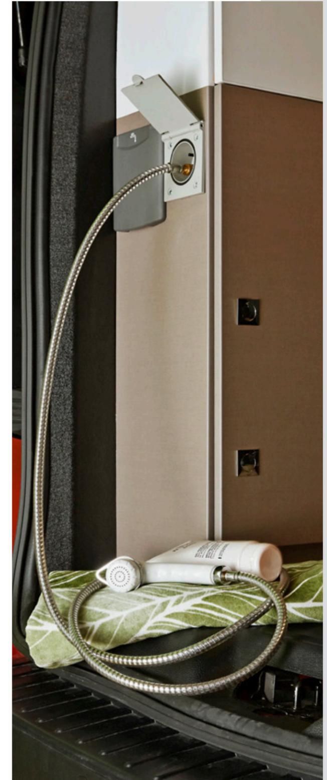
Anschluss für die Außendusche (Brausekopf mit Schlauch über Bürstner Zubehör „OTZ“ erhältlich).
